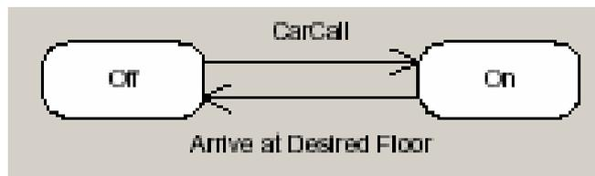
图 23: CarButtonControl 的状态图
